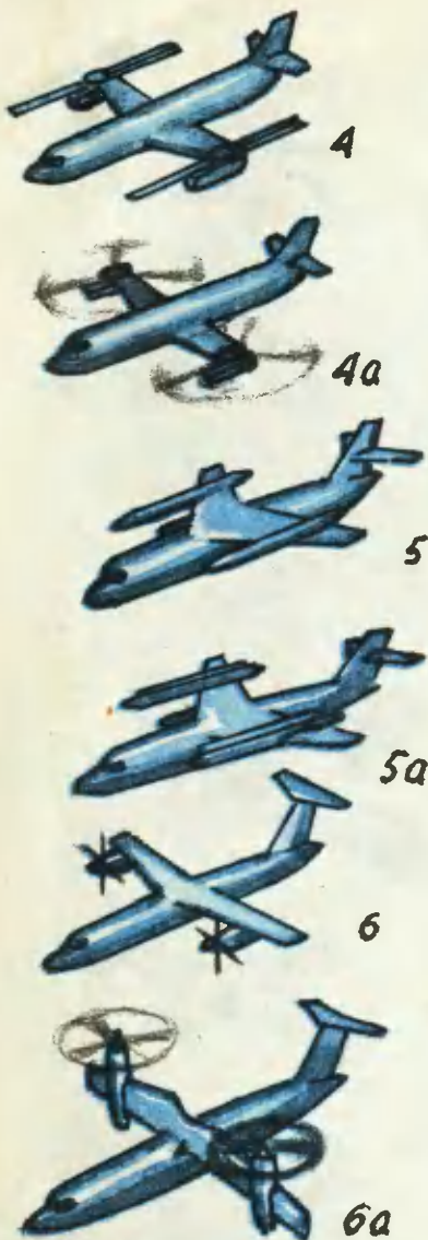
4а — аппарат с останавливающими в горизонтальном полете несущими винтами; 5 и 5а — самолет со специальными подъемными двигателями и маршевой силовой установкой; 6 и 6а — самолет с поворотными винтами, служащими также для управления летательным аппаратом при взлете и посадке.
